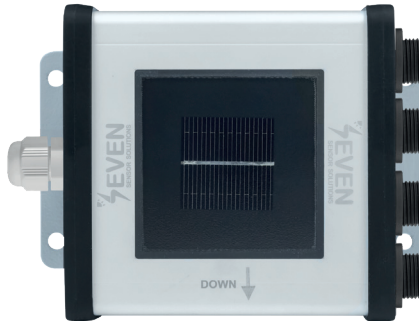
Görsel 4 - 3S-IS-mV SEVEN Referans Işınım Sensörleri
