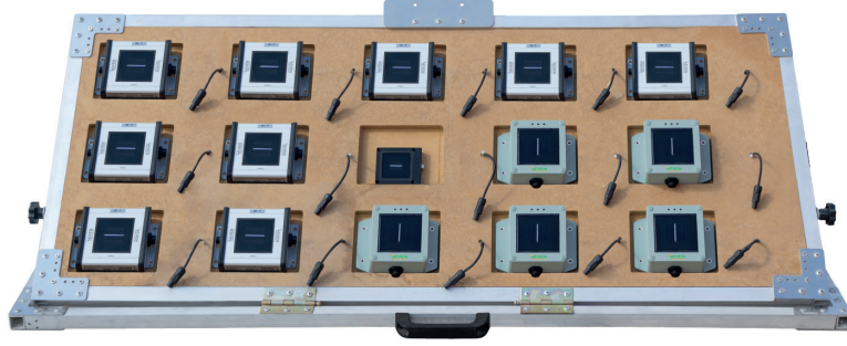
Görsel 5 - Taşınabilir ve Ayarlanabilir Kalibrasyon Sehpa'sı
